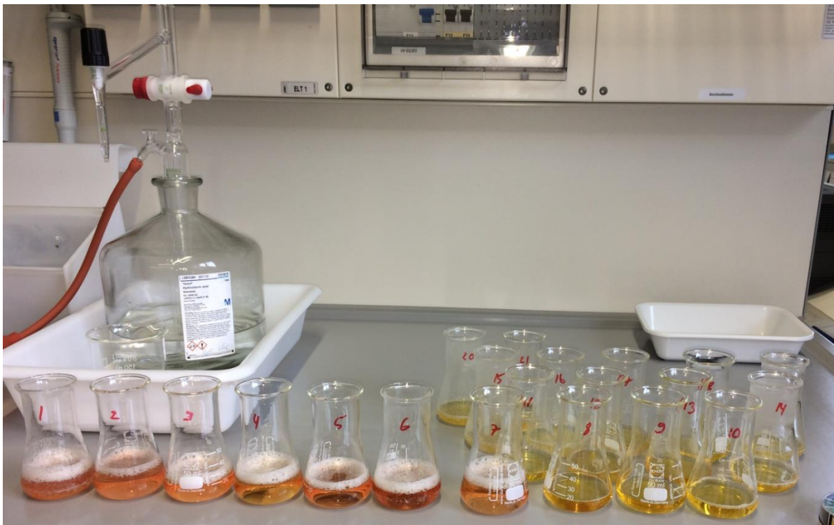
Abb. 3: Titration der NSBA bis zum Farbumschlag nach orange-rot
