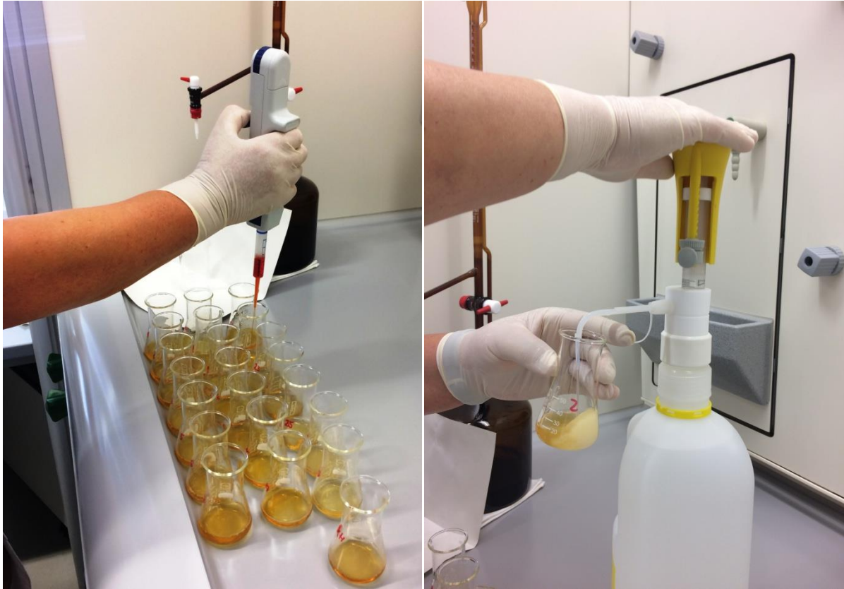
Abb. 2 a und b: Zugabe von Phenolrot als Indikator (links) sowie Formaldehyd (rechts) bei der Bestimmung der NSBA
